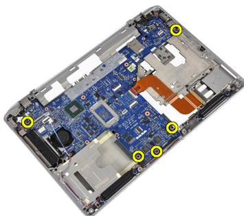
7. Soulevez partiellement le bord gauche de la carte système d'environ 45 degrés.
