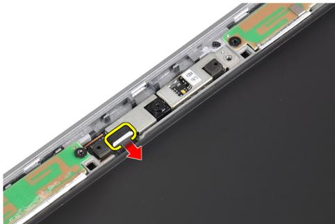
5. Retirez le module caméra et microphone de l'ensemble écran.
