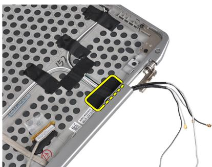
6. Retirez les câbles d'antenne de l'ouverture de la paroi de la charnière d'écran droite.
