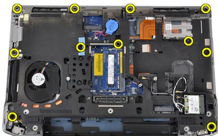
**4.** Retirez les vis qui fixent l'ensemble du repose-mains à l'avant de l'ordinateur.
