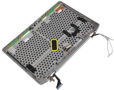
4. Débranchez le câble de la caméra du module caméra et microphone.
