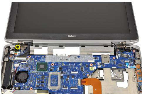
6. Retirez les vis de fixation du support LVDS.
