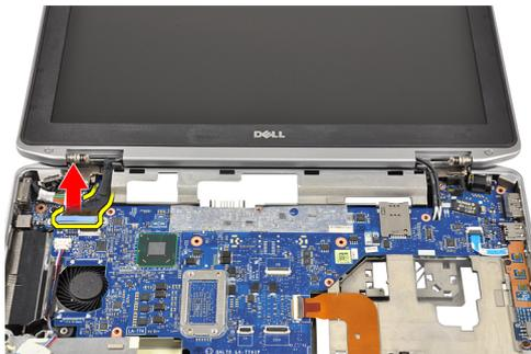
9. Tirez les câbles d'antenne par l'ouverture de la carte système.
