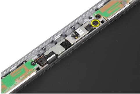
4. Débranchez le câble du module caméra et microphone du module.
